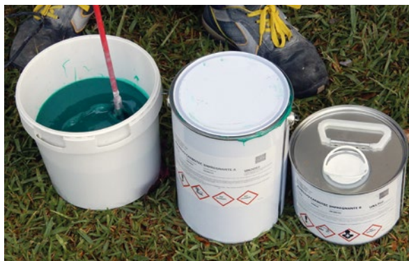
Preparación del Adhesivo Carbotec Impregnante
