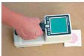
Mesure des paramètres colorimétriques.
