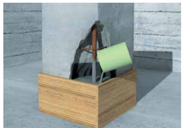
Réparation par mortiers fluides
