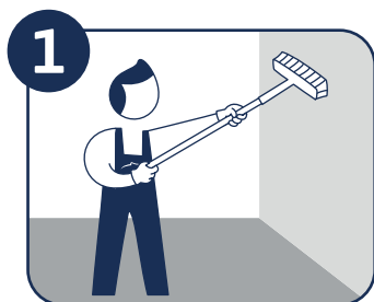
Preparar y limpiar el soporte. Comprobar resistencia.
