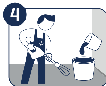
Mezclar el producto, mecánicamente, con el agua indicada en ficha técnica y en el envase.
