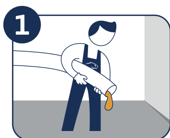
Verter y extender el hormigón
