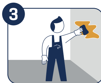
Humedecer la superficie sin que quede exceso de agua.
