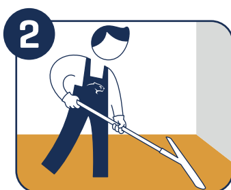
Alisar el hormigón
