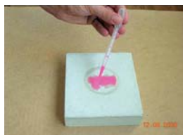
Aplicación de una solución de rodamina sobre la superficie de la muestra.
