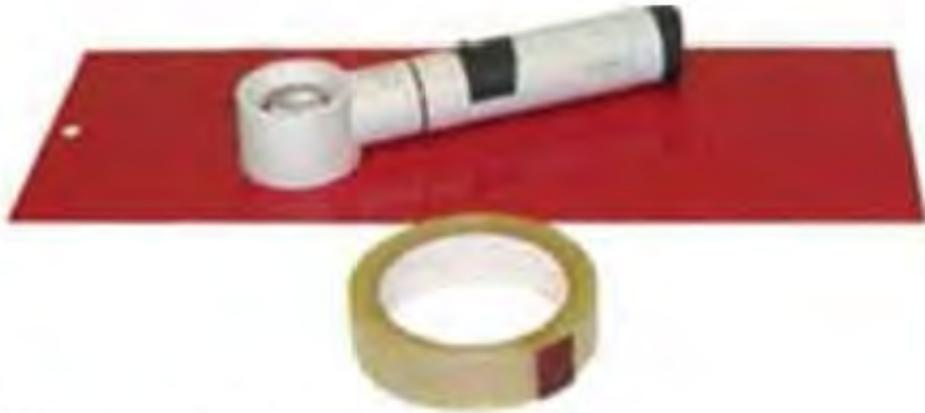
*Figura B.9: Cinta adhesiva transparente, lámpara de aumento y fondo para medir la contaminación de la superficie*
