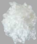
Fibre de verre résistant aux alcalis, haute intégrité, pour le renforcement du béton.
