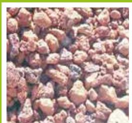
Galet rouge d'origine volcanique pour la décoration de surfaces extérieures et de projets paysagers. La perméabilité et la capacité de drainage du gravier volcanique maintiennent l'humidité du substrat et facilitent la croissance des plantes.
