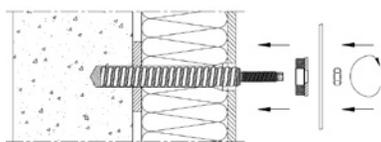
Dejar curar el producto unos 45 minutos a una temperatura de 20°C. Una vez fraguado, retirar la pieza de montaje, colocar elemento de sellado y, posteriormente, el accesorio requerido.
