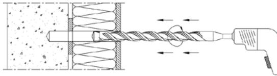
Realizar un taladro de Ø24mm que penetre en el soporte al menos 60 mm en el caso de hormigón y 80 mm en el caso de mampostería. Una vez realizado, se procederá a su limpieza con cepillo y aire a presión sin utilizar agua.
