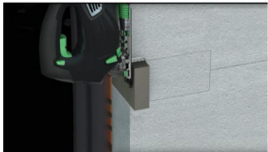
En caso de que el ángulo sea mayor que el espesor de las placas del sistema Traditerm, se podrá eliminar el sobrante con una sierra mecánica. El hueco en el que se realizan los anclajes, será cubierto con una placa aislante Traditerm de menor espesor, para enrasar esta parte con la fachada.
