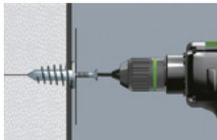
Fijar la carga correspondiente sobre Traditerm Anclaje Espiral con un tornillo de Ø4-5 mm, de Ø8-10 mm ó M8.
