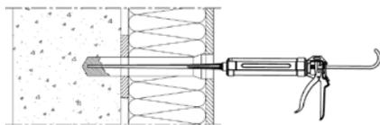
Rellenar el taladro o tamiz, en caso de soportes de fábrica de ladrillo, con resina Multifix USF hasta completar el hueco realizado en el muro. La boquilla tendrá una extensión correspondiente al espesor del aislamiento.
