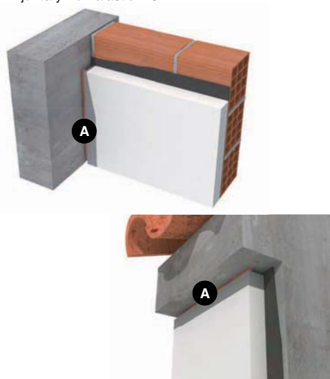
Detalles de aplicación fondo de junta + Pumalastic MS (A)
